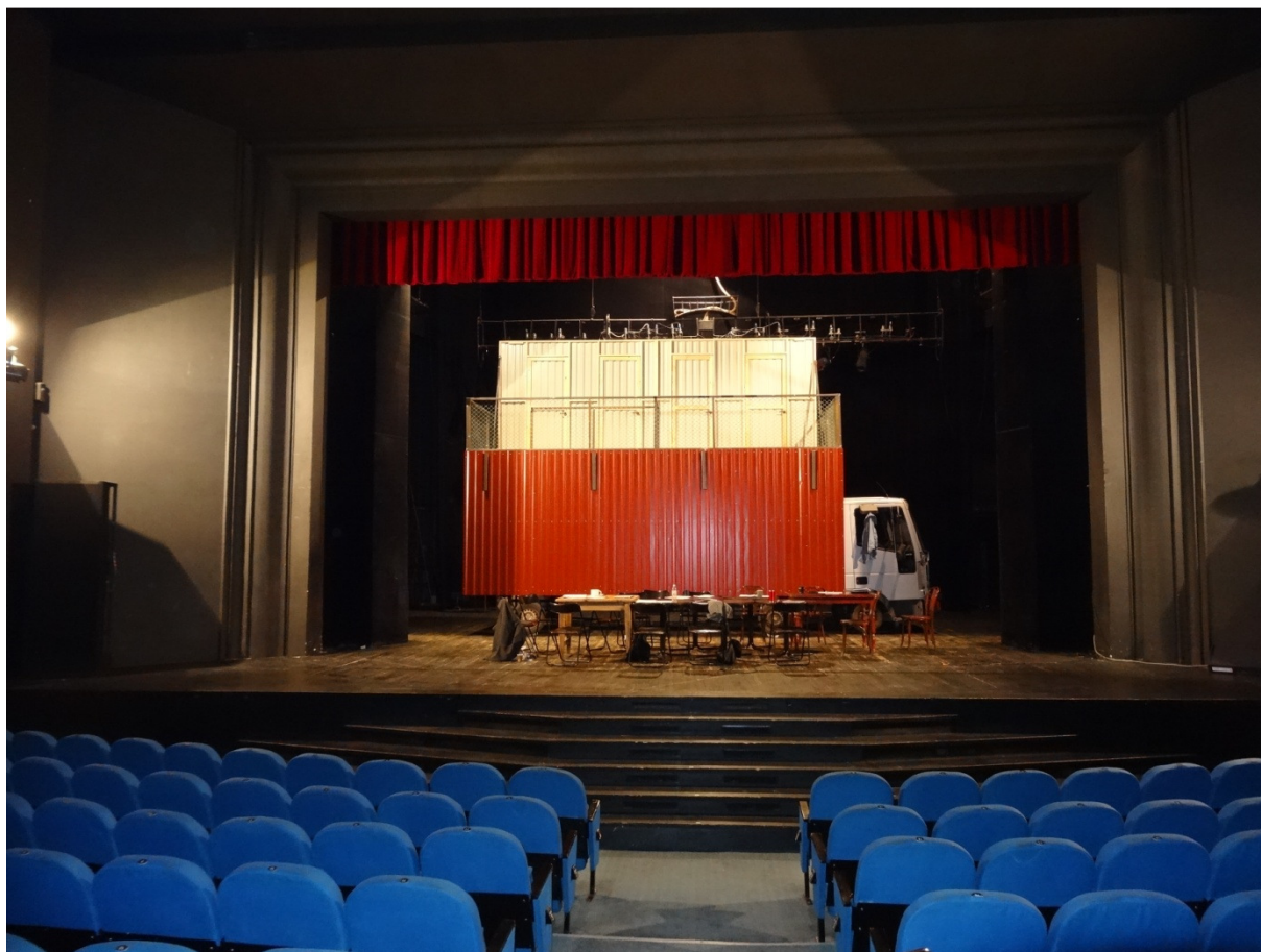
2933 otwór sceniczny przewidziany do zastosowania kurtyny przeciwpożarowej.
